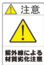
屋外設置など紫外線の影響でPVCの材質劣化を促進する場合があります。材質劣化により流量計の使用ができなくなる場合も発生しますのでご注意ください。
