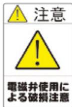
電磁弁を使用している急激な弁開閉運転をおこなうと内部部品の衝撃でガラスが破損する場合があります。
