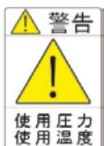
最高使用圧力、使用温度範囲 仕様の限度を超えて使用しますとガラスターバ管が破損して人体に危害が加わるおそれがあります。
