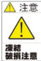
冬季など流体が凍結した場合にガラスが流体凍結膨張により破損割れが発生して人体に危害が加わるおそれがあります。
