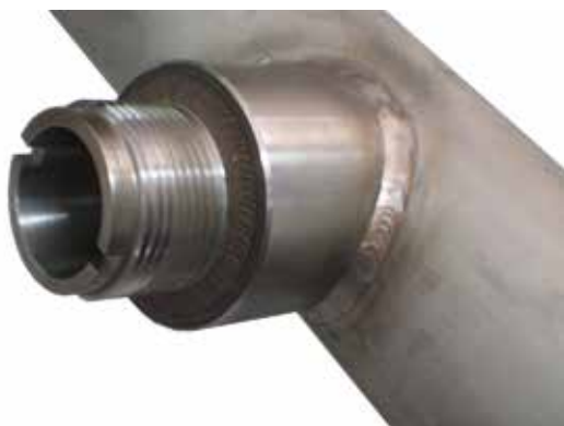
WTS050 既設配管溶接例
