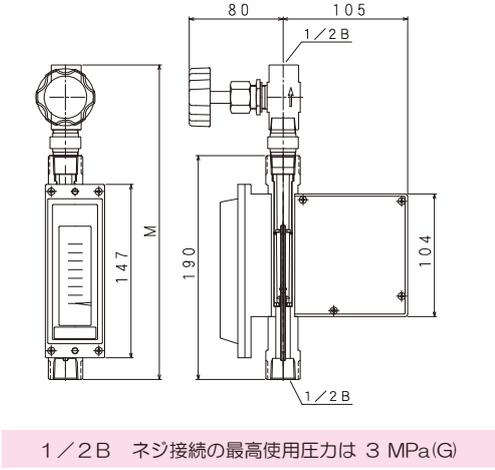
1/2 B ネジ接続の最高使用圧力は 3 MPa(G)
