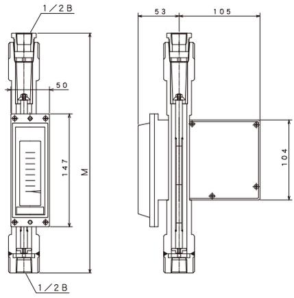
1/2 B ネジ接続の最高使用圧力は 5 MPa(G)
