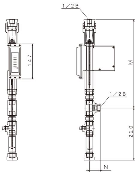
1/2 B ネジ接続の最高使用圧力は 3 MPa(G)
