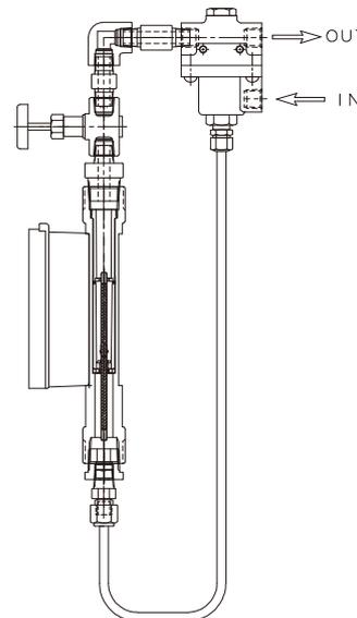
定差圧弁の機能により、出入口の圧力変化に対し、定流量弁のダイヤフラムの機能が一定流量を保持しますので液面制御に使用できます。
