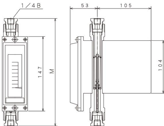
1/4 B ネジ接続の最高使用圧力は 5 MPa(G)
