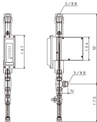
3/8 B ネジ接続の最高使用圧力は 5 MPa(G)
