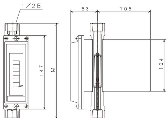
1/2 B ネジ接続の最高使用圧力は 9.8 MPa(G)
