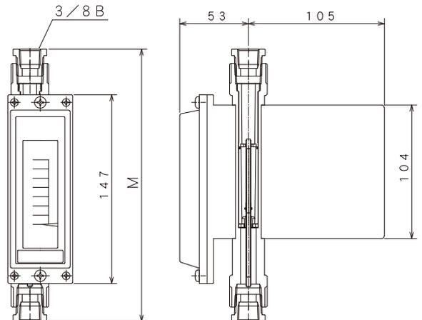
3/8 B ネジ接続の最高使用圧力は 5 MPa(G)
