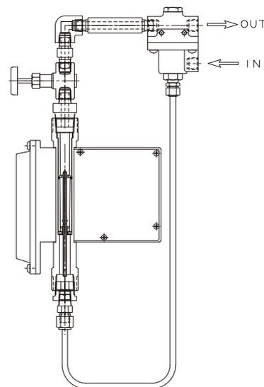
定差圧弁の機能により、出入口の圧力変化に対し、定流量弁のダイヤフラムの機能が一定流量を保持しますので液面制御に使用できます。
