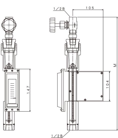
1/2 B ネジ接続の最高使用圧力は 3 MPa(G)
