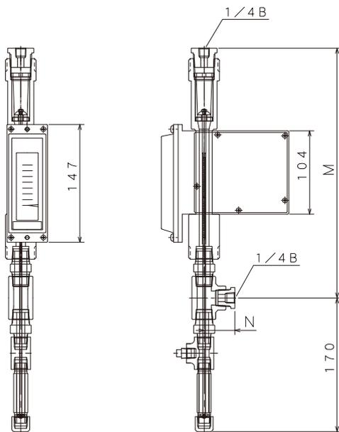
1/4 B ネジ接続の最高使用圧力は 3 MPa(G)
