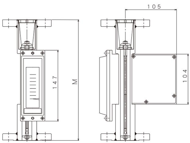
フランジタイプで JIS 10K 以外では M 寸法が長くなります。以下の寸法をプラスして下さい。
