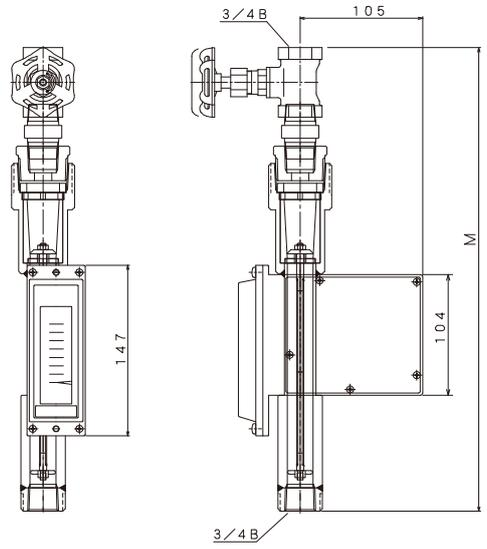
3/4 B ネジ接続の最高使用圧力は 3 MPa(G)
