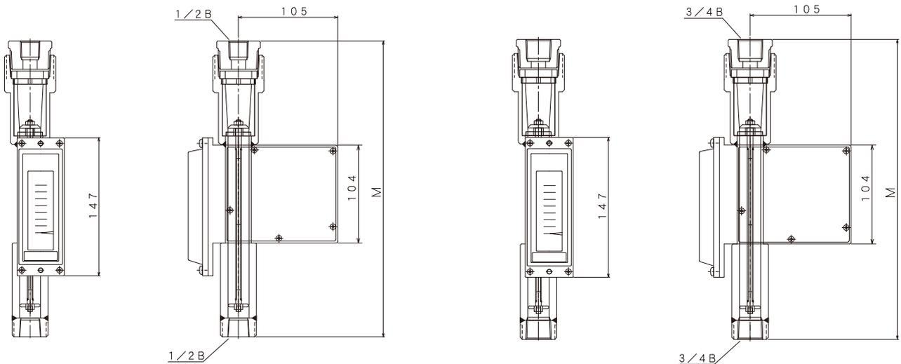
1/2B ネジ接続の最高使用圧力は 3 MPa(G)
