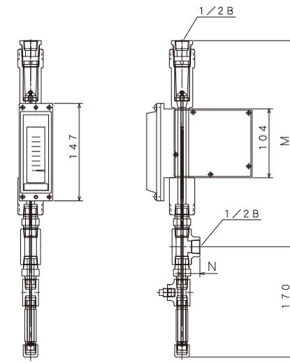
1/2 B ネジ接続の最高使用圧力は 5 MPa(G)
