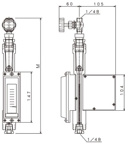
1/4 B ネジ接続の最高使用圧力は 5 MPa(G)
