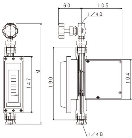
1/4 B ネジ接続の最高使用圧力は 3 MPa(G)
