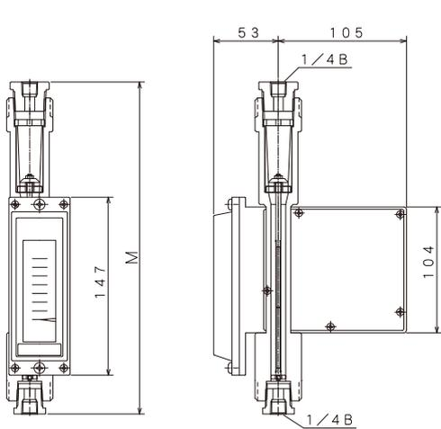
1/4 B ネジ接続の最高使用圧力は 5 MPa(G)
