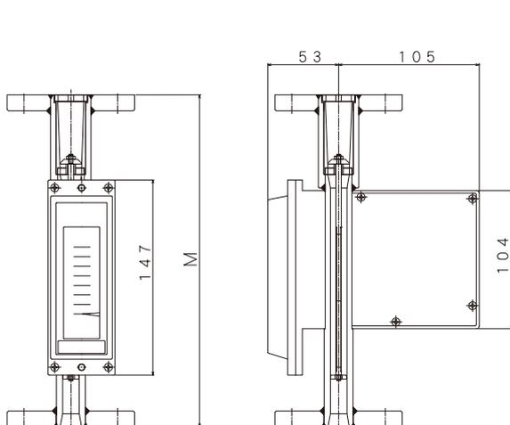
1/2 B ネジ接続の最高使用圧力は 5 MPa(G)
