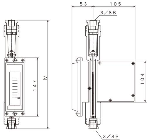
3/8 B ネジ接続の最高使用圧力は 5 MPa(G)
