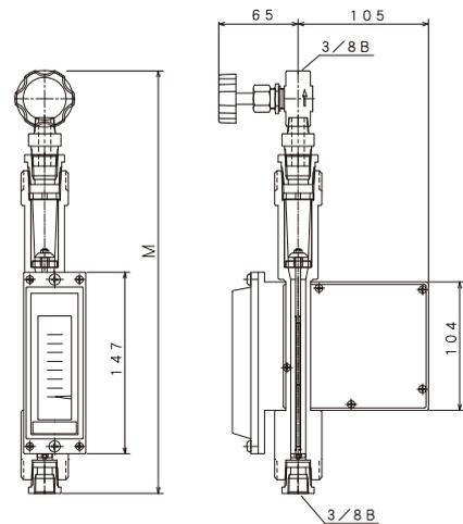
3/8 B ネジ接続の最高使用圧力は 5 MPa(G)
