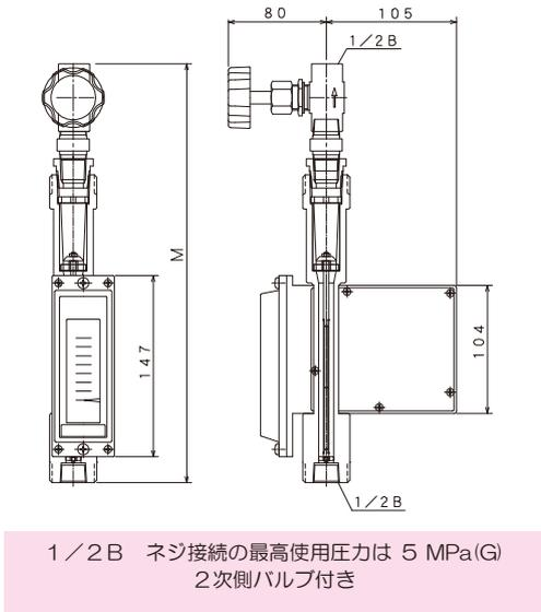
1/2 B ネジ接続の最高使用圧力は 5 MPa(G)
