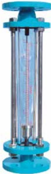
GTFシリーズは配管に直接、垂直に取付け、配管内に液体、気体が今、どれだけ流れているか瞬時流量を測定し、その測定値を現場にて直読出来るシンプルで使いやすい面積流量計です。ガラステーパ管表面の流量目盛は刻みを入れて朱色入れをしていますので視認性が良好です。
